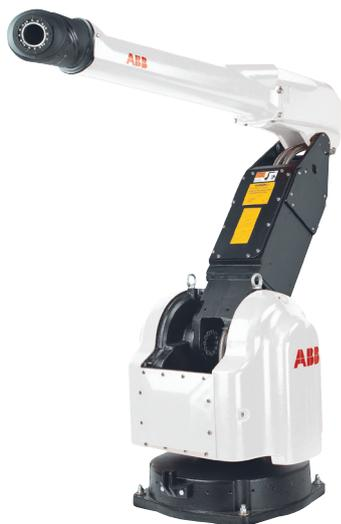
ABB高精度“中空手腕”采用直线设计能够避免对漆料管和空气管造成磨损, 提高系统总体可靠性。手腕可沿任意方向旋转140°, 这种高度柔性使IRB 580一跃成为同类喷涂机器人中通用性最强、编程最便捷的产品之一。
